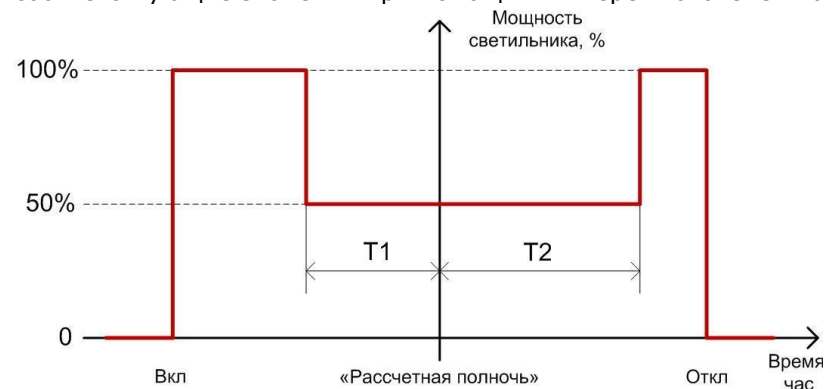
Рис 1. График диммирования по двум уровням мощности 100/50%
